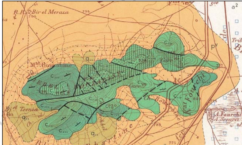
Figure 6 : Extrait d'une carte géologique montrant les contours de différentes couches géologiques (traits fins continus ou pointillés), ainsi que des failles apparentes et cachées (traits épais continus ou pointillés).
