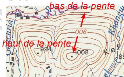
Figure 6 : Extrait d'une carte topographique montrant des courbes de niveau. Les courbes maîtresses sont en traits épais, et les courbes normales en traits fins. Sur la courbe maîtresse, le haut du chiffre (altitude à 900 m) donne le haut de la pente.
