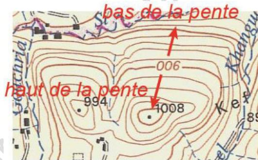
Figure 6 : Extrait d'une carte topographique montrant des courbes de niveau. Les courbes maîtresses sont en traits épais, et les courbes normales en traits fins. Sur la courbe maîtresse, le haut du chiffre (altitude à 900 m) donne le haut de la pente.
