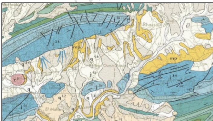
Figure 5 : Exemple d'une carte géologique montrant les différentes couleurs standards (extrait de la carte géologique de Brezina, Algérie, échelle : 1/200 000 ; Feuille HI – 11 12).
